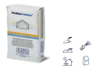
Revoco termoaislante, a base de aglomerante hidráulico y material inerte de poliestireno, conforme la norma EN 998-1 y clasificado T-CSI-W1. Se puede aplicar a mano o a máquina. Espesor mínimo de aplicación: 20 mm. Ofrece una excelente transpirabilidad totalmente compatible con paredes incluso irregulares de ladrillo, bloques de hormigón, hormigón en bruto, etc.
