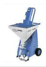
Es un mezclador monofase "Ritmo" para amasar y aplicar colas y regularizadores. Gracias al motor de 230 V se puede alimentar con corriente comúnmente presente en los edificios. Mezclador sencillo y rápido de limpiar.
