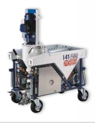
La revocadora I 41 es adecuada para empastar y bombear cualquier tipo de revoco premezclado o mortero seco que se pueda trabajar a máquina. En el caso de productos de tipo revoco termoaislante THERMOBENESSERE se deben utilizar los accesorios adecuados. Mezcla uniforme y dosificación constante del agua.
