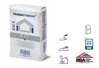
Adhesivo regularizador cementoso de elasticidad media, con granulometría < 0,6 mm, cumple con la norma EN 998-1 y está clasificado GP-CSIV-W2; disponible en saco. Ofrece la máxima adherencia al soporte de todo el Sistema S.A.T.E. y una elevada resistencia a la compresión. Se usa para encolar y regularizar paneles aislantes de EPS para embeber mallas de armadura y para regularizar superficies de hormigón y elementos prefabricados.
