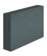
Paneles aislantes de dimensión 100x50 cm, adicionados con grafito para un mejor aislamiento térmico, clasificados según la norma EN 13163 y fabricados mediante corte con hilo caliente de bloques perfectamente estabilizados.
