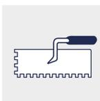
Si el soporte es lo suficientemente plano, el producto se extiende sobre toda la superficie del panel con una llana de dientes anchos, con dentadura variable de acuerdo con la regularidad del soporte, tomando la precaución de no inclinar demasiado la llana
