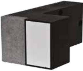
Las placas de montaje FASSA TRA-WIK-PH están realizadas en espuma poliuretánica rígida, imputrescible, teñidas en masa en color negro, sin CFC, reforzadas con una placa de acero para fijar los elementos externos y una placa compacta (HPL) que asegura una distribución óptima de la presión sobre la superficie del elemento.
