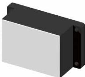
Las placas de montaje universales FASSA UMP-ALU-TR están realizadas en espuma poliuretánica rígida, imputrescible, sin CFC, reforzadas con dos pletinas de acero con inyección de espuma para garantizar el atornillado al soporte, una placa de aluminio para fijar los elementos externos y una placa compacta (HPL) que asegura una distribución óptima de la presión sobre la superficie del elemento.
