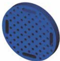
Las arandelas de fijación FASSA DORONDO son arandelas de plástico de alta calidad. La superficie interna tiene una estructura encrespada, mientras que la superficie externa está perforada. Las medidas son las siguientes: diámetro 90 mm, diámetro útil 70 mm y espesor 10 mm.
