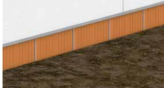
La instalación de los paneles debe planificarse previendo entre los paneles juntas desfasadas respecto de los huecos de puertas y ventanas y de discontinuidades de los materiales del soporte (por ejemplo, respecto de la interfaz ladrillo/hormigón).
