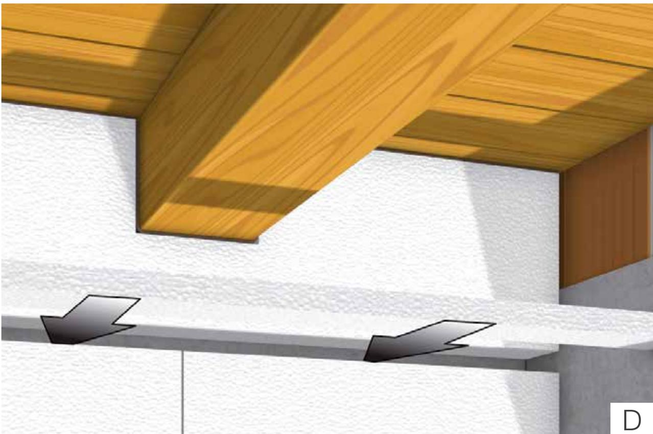
La aplicación de la cinta de unión en las esquinas no debe hacerse de manera continua. En las esquinas o ángulos, cortar la cinta prestando atención en unir los extremos perfectamente al soporte (C).
